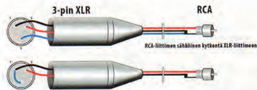
RCA-liittimen sähköinen kytkentä XLR-liittimeen.
